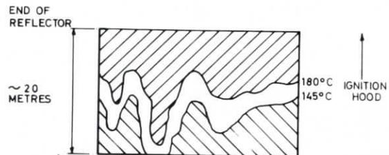
FIGURE 7b GRAPH SHOWING ISOTHERMS ON THE SURFACE OF A SINTER STRAND
